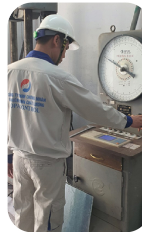
Máy kéo thép vạn năng WE-1000B gắn đầu đọc điện tử
